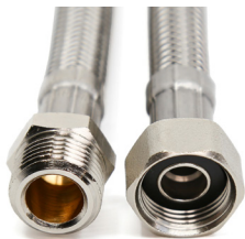
Beispiel geeigneter Flexschlauchanschlüsse: G 3/8"-Überwurfmutter zum Anschluss an das UVC-LED-Modul und G 3/8"-Außengewinde zur Verbindung mit der Wasserinstallation.
