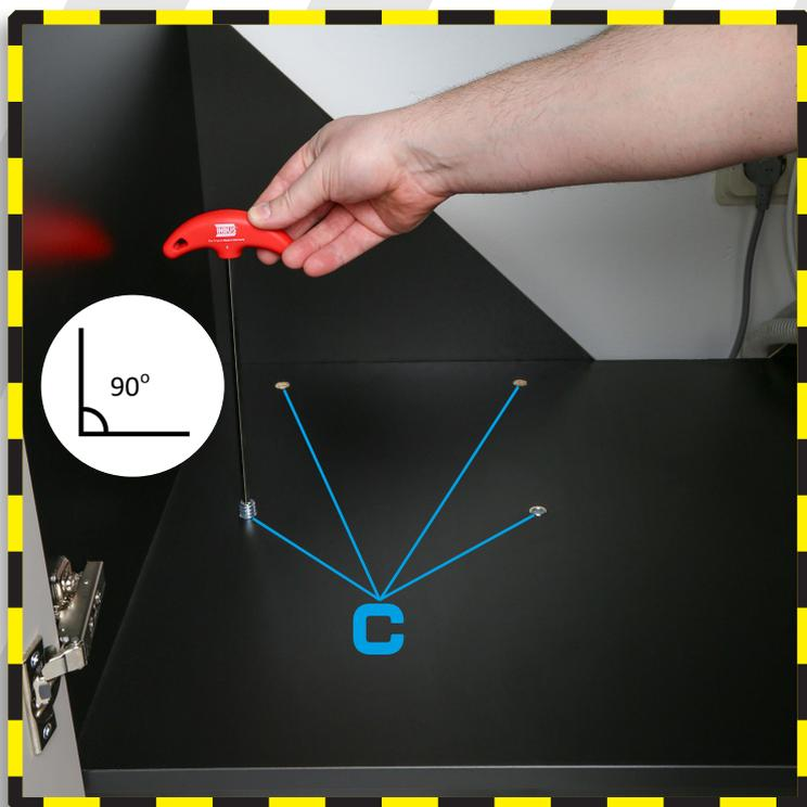
5. Drehen Sie in jedes Bohrloch eine Einschraubmuffe (C) im rechten Winkel ein, und verwenden Sie dazu einen 6er-Inbusschlüssel. (G) Achten Sie besonders am Anfang des Eindrehen darauf, dass dies senkrecht erfolgt und die Einschraubmuffe (C) sich nicht verkantet.
