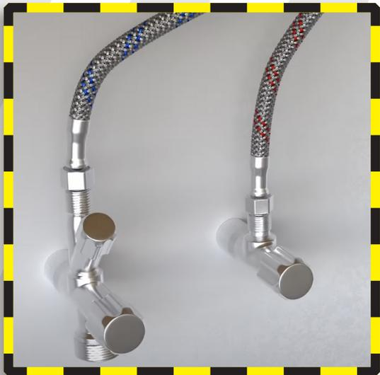
Jetzt können Sie die Schläuche für warmes und kaltes Wasser (3/8") an die Eckventile in der Wand anschließen. Zum Festziehen der Metallmutter verwenden Sie einen Schlüssel in der Größe 19.
